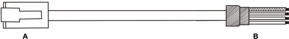
图4.9 伺服驱动器与PLC通讯线缆示意图
